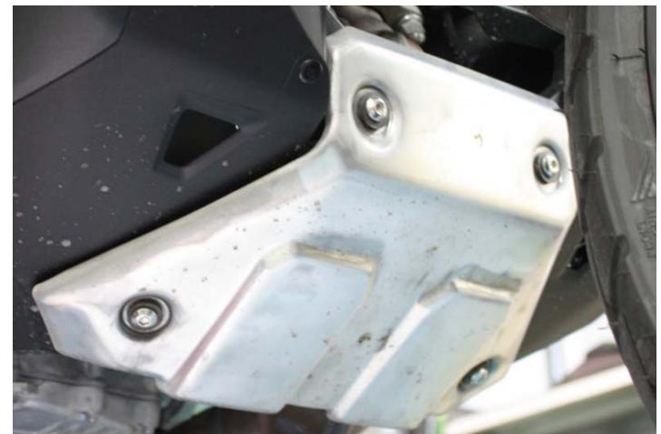
**IT** · Rimontare la protezione motore
