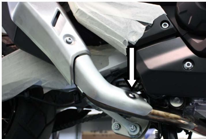
**IT** · Svitare la vite indicata e rimuovere la protezione inferiore
