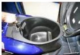
**Retirer les 4 vis avec une clé à pipe de 10 et retirer le coffre.**
