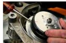
Placer le rotor sur le vilebrequin en positionnant les repères rouges du stator et du rotor l'un en face de l'autre
