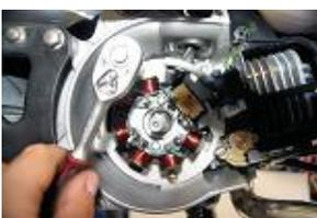
**Déposer le stator avec une clé a pipe de 8 et retirer le faisceau.**
