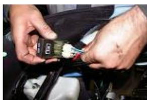
**Déposer la CDI d'origine et débrancher les 2 connecteurs.**
