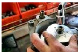
Fixer le bloc piston en le resserrant doucement et serrer le rotor avec l'écrou d'origine puis une fois le rotor serré re-contrôler que les repères rouges coïncident au point mort haut.
