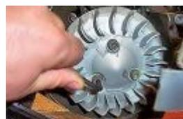
Resserrer la ventilateur ou les pions d'entraînement de pompe à eau pour les modèles liquides avec les vis d'origine.
