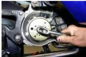
**Desserrer l'écrou du rotor a l'aide d'une clé à pipe de 17.**
