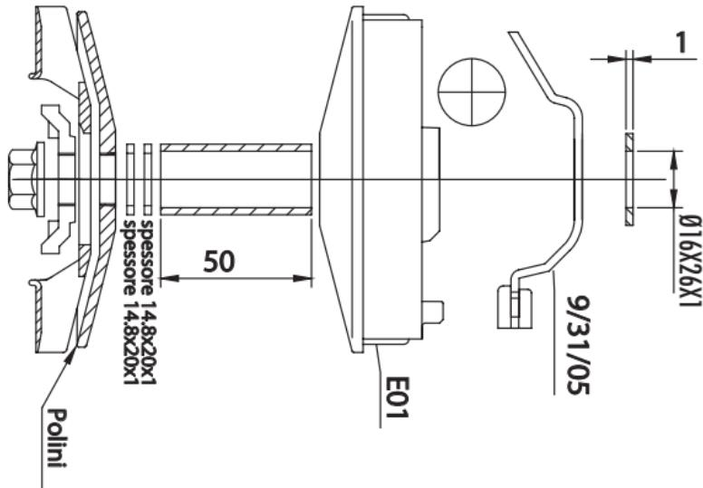
Regolazione con cinghia usurata sp. 19 - Adjustment with worn th. 19 belt - régulation avec courroie préte à usure épaisseur 19
