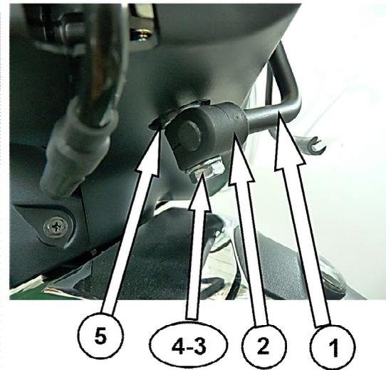
Pre assemblare fissaggio inferiore e piastrino superiore senza stringere. Preassemblare il kit di montaggio lastra sulla stessa.
