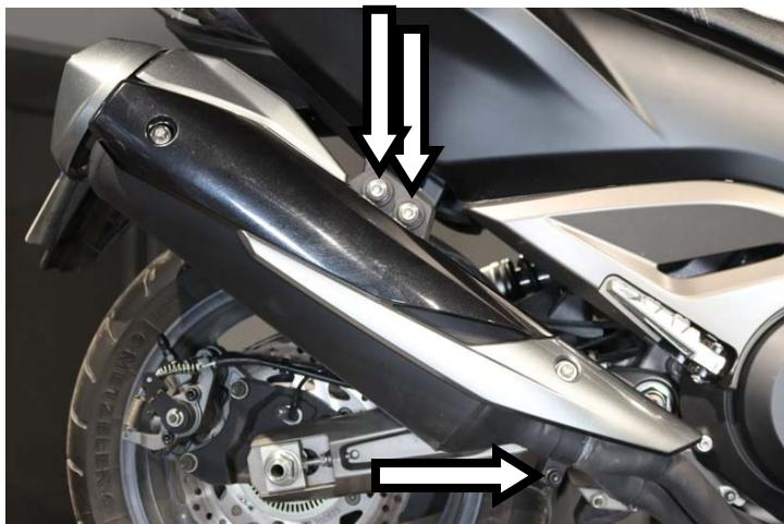
**IT** · Allentare la fascetta, svitare le due viti di fissaggio e rimuovere il terminale
