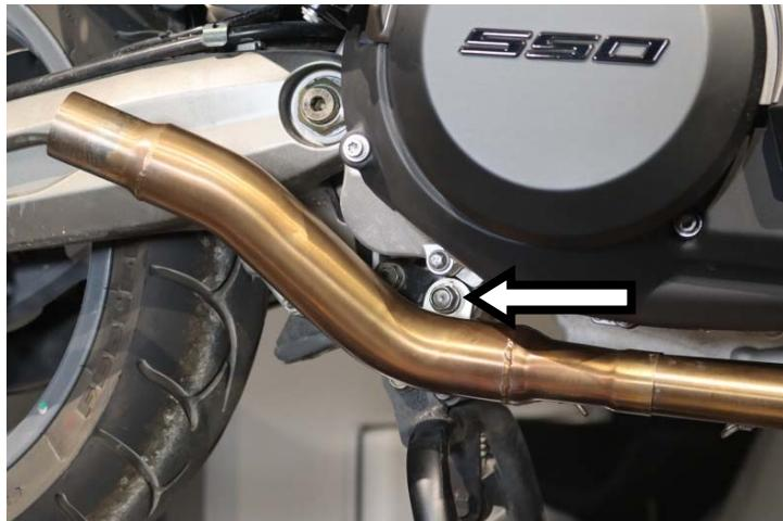
**IT** · Innestare il raggruppamento e serrare senza stringere completamente l'attacco mediante vite originale
