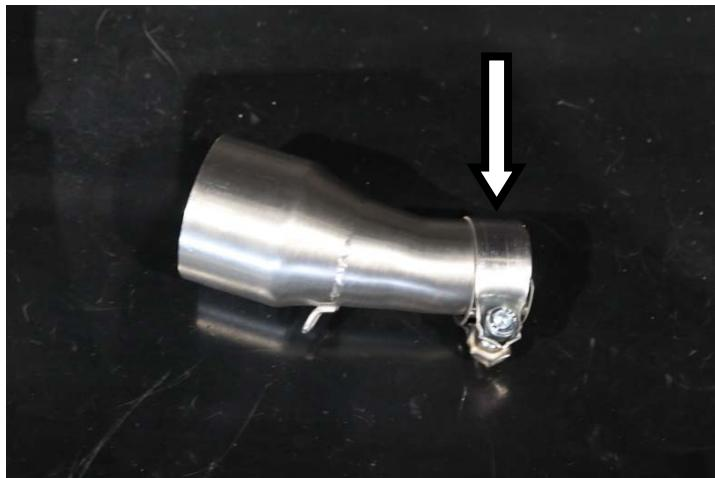
**IT** · Alloggiare la fascetta fornita nel kit di montaggio nell'innesto del raccordo
