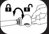
S.G.A.S. (sistema patentado anti-flaneo) con nueva válvula con tapón integrado y cierre hermético de rosca. Adaptador S.G.A.S. en dotación para inflar con la boca/con una bomba: para un inflado higiénico evitando la salida de aire mientras se cierra la válvula.
