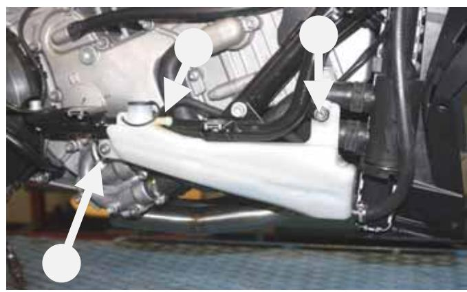
**- Solo in caso di montaggio del kit collettori 191.0020:** rimuovere le viti che fissano la vasca di recupero del liquido refrigerante, scollegare il tubo in gomma e spostarlo in modo da accedere più facilmente ai collettori
