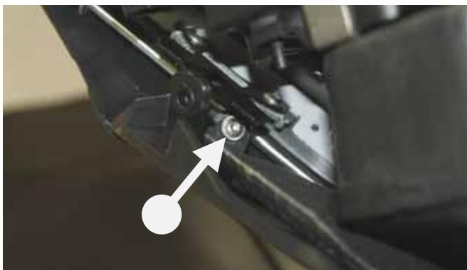
**- Solo in caso di montaggio del kit collettori 191.0020:** scostare la plastica della carena DX e rimuovere la vite indicata vicino alla batteria
