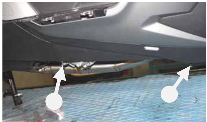
**- Solo in caso di montaggio del kit collettori 191.0020:** rimuovere i perni in plastica sulla parte inferiore della carenatura
