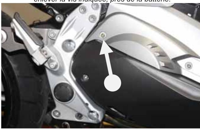
**- Solo in caso di montaggio del kit collettori 191.0020:** rimuovere la vite indicata e rimuovere tutta la carena DX
