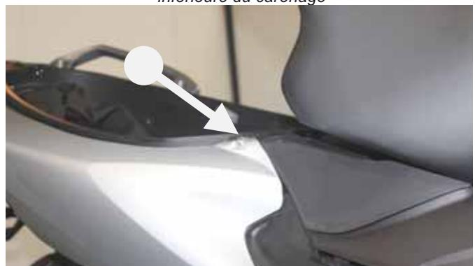
**- Solo in caso di montaggio del kit collettori:** svitare la vite indicata
